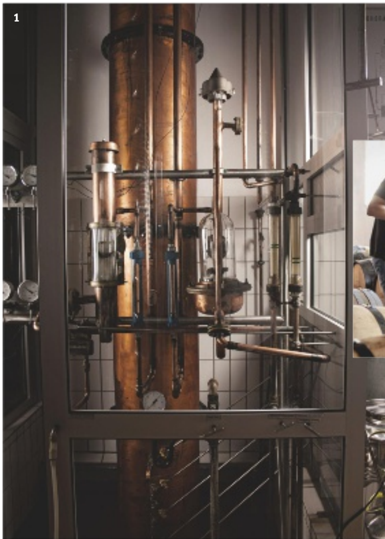
1 In der Rektifikationsanlage wird aus der fermentierten Maische destilliert, was später zum Korn heranreift 2 Georg Glitz-Ehringhausen nimmt eine Fassprobe – abgefüllt wird erst, wenn die Harmonie perfekt ist 3 Gereifter Dinkelkorn und klassischer Kornbrand überzeugen solo wie auch im Cocktail
